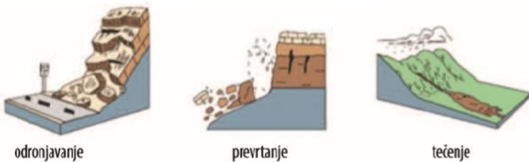
Slika 16: Prikaz osnovnih tipova klizanja prema mehanizmu kretanja
